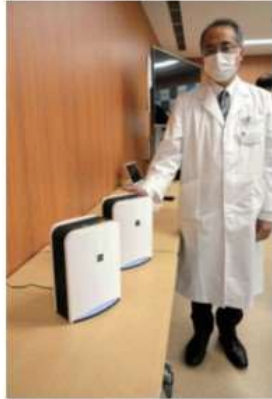
深紫外線LEDを活用した空間除菌消臭装置=2020年5月27日、宮崎市の宮崎大学医学部、二宮俊彦撮影
